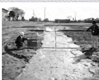
地盤変動による沈下
